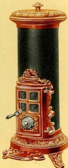
Appareil à feu continu et visible pour coke et anthracite. Fût tôle glacée, garniture intérieure en briques réfractaires. Tiroir en tôle à l'intérieur, grille mobile à décrochage extérieur. Se livre toujours émaillé.
