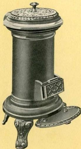
Appareil à feu continu entièrement en fonte, intérieur en briques réfractaires, avec cuvette et tampon sur le dessus, permettant le chauffage au charbon et au bois. Buse derrière. Toujours livré en fonte vernie noire.
